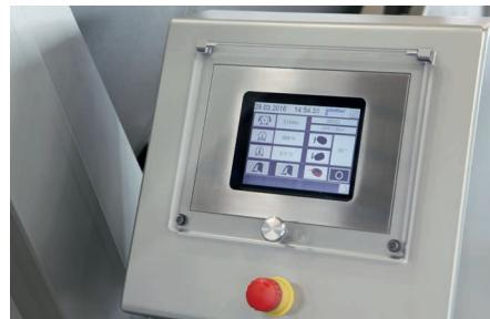
Alle Anlagenfunktionen und Prozess-Programmabläufe werden über einen Touchscreen Monitor gesteuert. All process data and functions are handled via touch screen operator panel. Todas las funciones y secuencias de programas se controlan por medio del teclado de membrana con display integrado.
